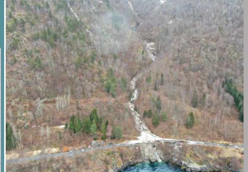
Figur 4 - Skredløp og treffpunkt veg. Merk at det har vore stor hastighet på skredmassane i skredløpet. Foto: J T SVV
